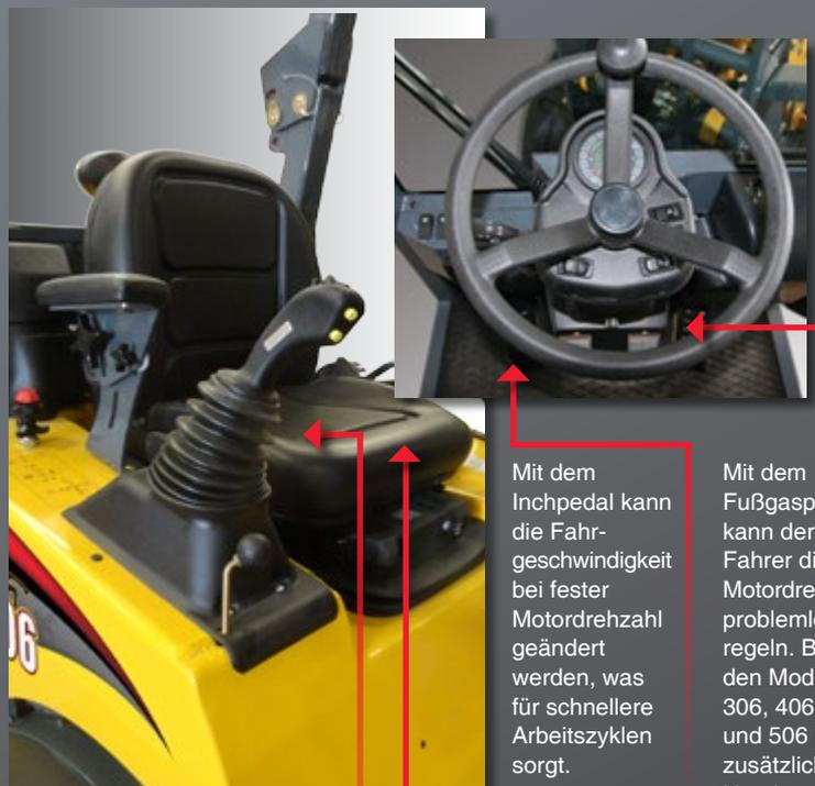
Der Multifunktionsjoystick steuert alle Funktionen im Hubgerüst und die Zusatzhydraulik. Bei den Modellen 306, 406 und 506 werden mit ihm auch die zwei Hydrostatikstufen und die Differenzialsperre geschaltet.
