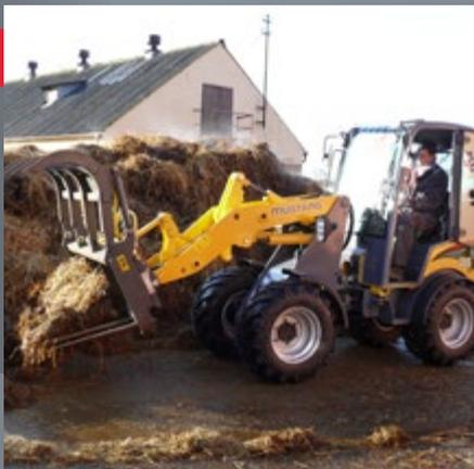
**KURZE TAKTZEITEN** ▲ beschleunigen ihre täglichen Arbeiten. Schnelle Lade-, Hebe-, Kipp- und Einrollvorgänge lassen Sie mehr in kürzerer Zeit erledigen. Die zwei Geschwindigkeitsstufen bei den Modellen 306, 406 und 506 sorgen für höhere Produktivität bei Fahrgeschwindigkeiten bis 19,9 km/h.
