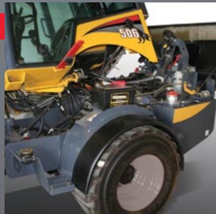
**WARTUNGSZUGANG** ▲ zum Motor, dem Kühlmittel und dem Hydrauliköl wird durch eine große Motorhaube erleichtert. Ein seitlich kippbarer Fahrerstand mit ISO-Befestigung lässt sich über Gasdruckfedern neigen, um so einen leichten Zugang zur Hydraulik und der Batterie zu ermöglichen.
