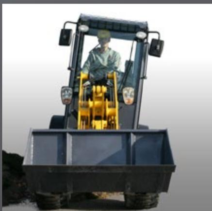
**STÄNDIGE TRAKTION** ▲ Das in beide Richtungen bis zu 10° schwenkbare Fahrgestell erhält die Traktion der Maschine. Selbst bei unebenem Terrain sorgt das Knickpendelgelenk dafür, dass die Reifen ständig mit dem Boden in Kontakt bleiben.
