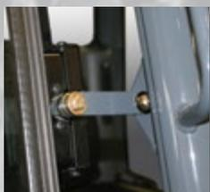
**BELÜFTUNG ▲** Die Türen der Fahrerkabine haben eine Verriegelung, mit der sie zwecks Belüftung teilweise geöffnet gehalten werden können.
